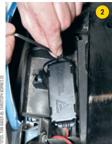
▲ Montieren: Sensor des Systems möglichst waagrecht am Motorrad fixieren; das klappt schnell per Kabelbinder
